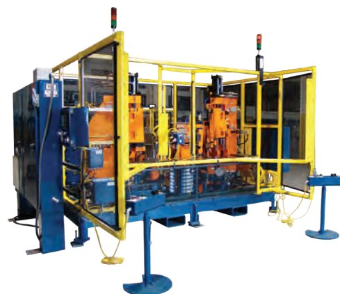
Dubbel arbetsstation som använder stuknitning för att sammanfoga artiklar för fordonsindustrin.
