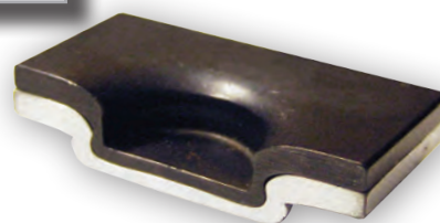
Genomskäring av en färdig fog. Lägg märke till hur plåten har formats till en överlappande knapp.
